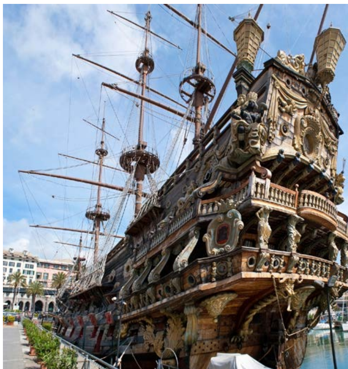
NEPTUN – replika galeonu zbudowana na potrzeby filmu „Piraci” Romana Polańskiego. Część podwodną okrętu stanowi metalowy kadłub wyposażony w wielokierunkowe sterowniki strumieniowe, natomiast góra (burty, pokład) jest wykonana z drewna. Okręt posiada działający takielunek i ożaglowanie.
